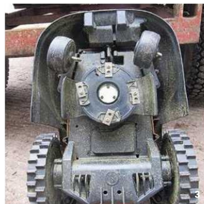
Různá řešení žacích čepelí – Robomow RS 615 (1) je vybaven dvěma třícípými noži, John Deere Tango E5 series II (2) má řešení podobné běžným sekačkám. Worx WG791E.1 (3) seká pomocí soustavy čtyř žiletkových nožů upevněných na plastovém kole.
