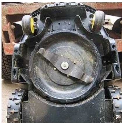
Různá řešení žacích čepelí – Robomow RS 615 (1) je vybaven dvěma třícípými noži, John Deere Tango E5 series II (2) má řešení podobné běžným sekačkám. Worx WG791E.1 (3) seká pomocí soustavy čtyř žiletkových nožů upevněných na plastovém kole.
